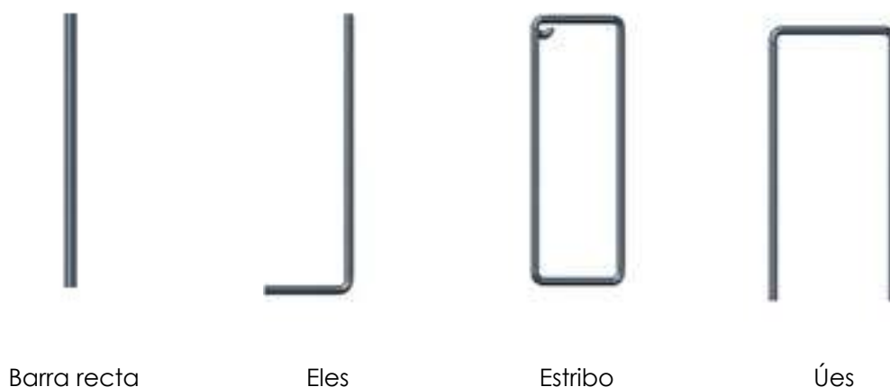
Figura 29 Refuerzos para paneles Sismo
